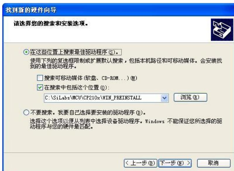
选中”在搜索中包含这个位置“，点击浏览，选择配套光盘中（若光盘的盘符为 X）X:\CP210X\WIN\_PREINSTALL 的目录或从 [WWW.ADVCOM.CN](http://WWW.ADVCOM.CN) 我公司网站下载结压缩后的目录，如下图，
